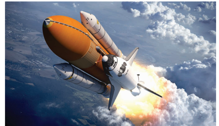
우주왕복선의 외부 표면에는 세라믹 코팅이 돼 있어 강력한 마찰열을 버틸 수 있다. © shutterstock.com
